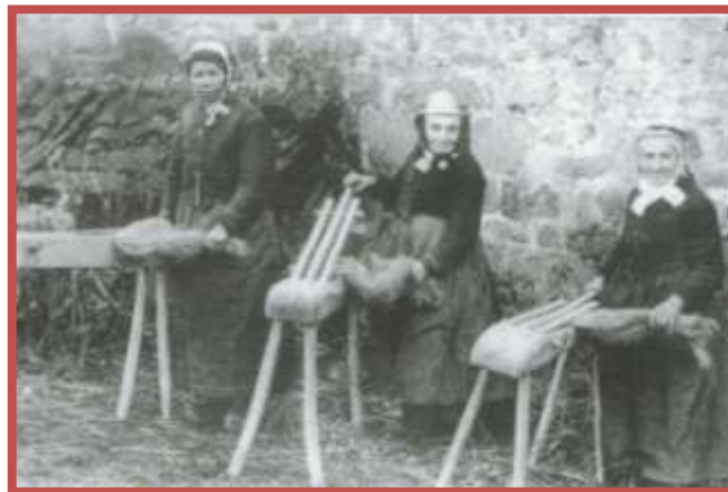
Les tiges de chanvre sont broyées à l'aide de la brege afin de les assouplir
